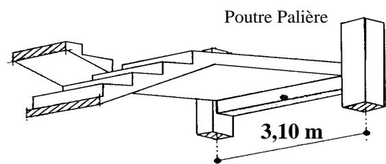
**-Fig.III.9-** schéma d'une poutre palière
