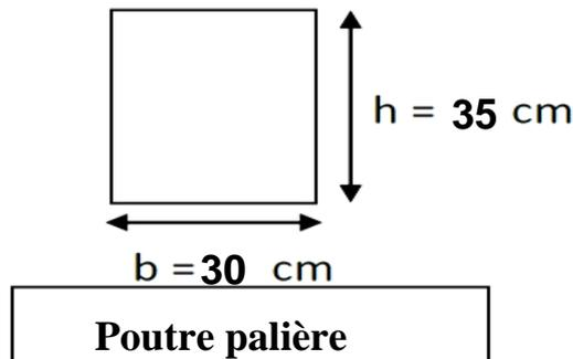
**-Fig.III.10-** schéma d'une poutre palière
