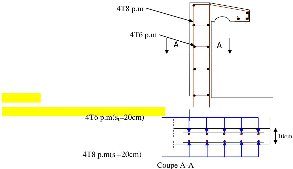
**-Fig.III.2-Schéma de ferrailage de l'acrotère**
