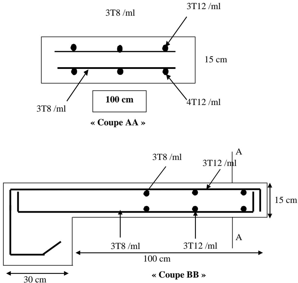
**-Fig.III.12-** schéma de ferrailage balcon (a).
