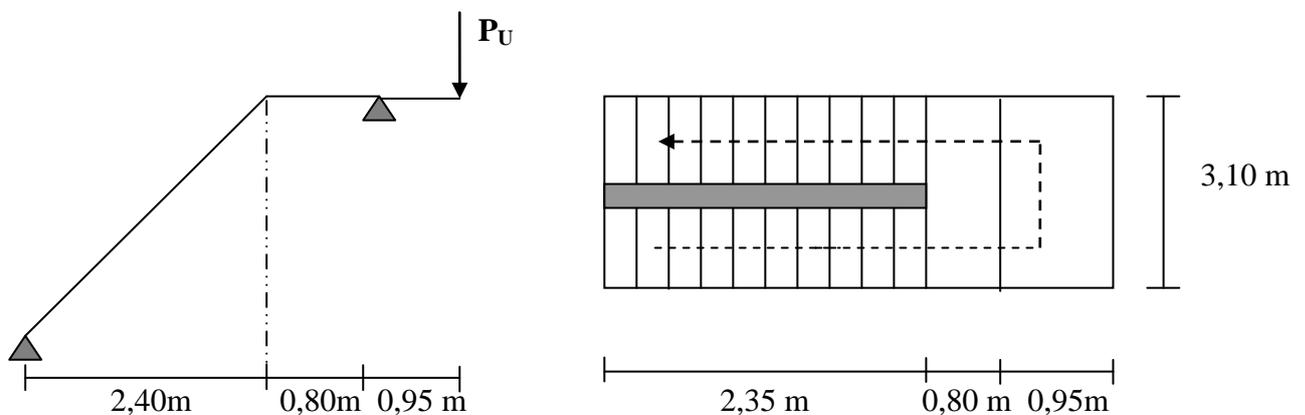
**-Fig.III.4-** schéma d'un escalier à deux volées.
