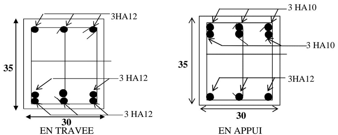
**-Fig.III.11-**Schéma de ferrailage de la poutre palière.
