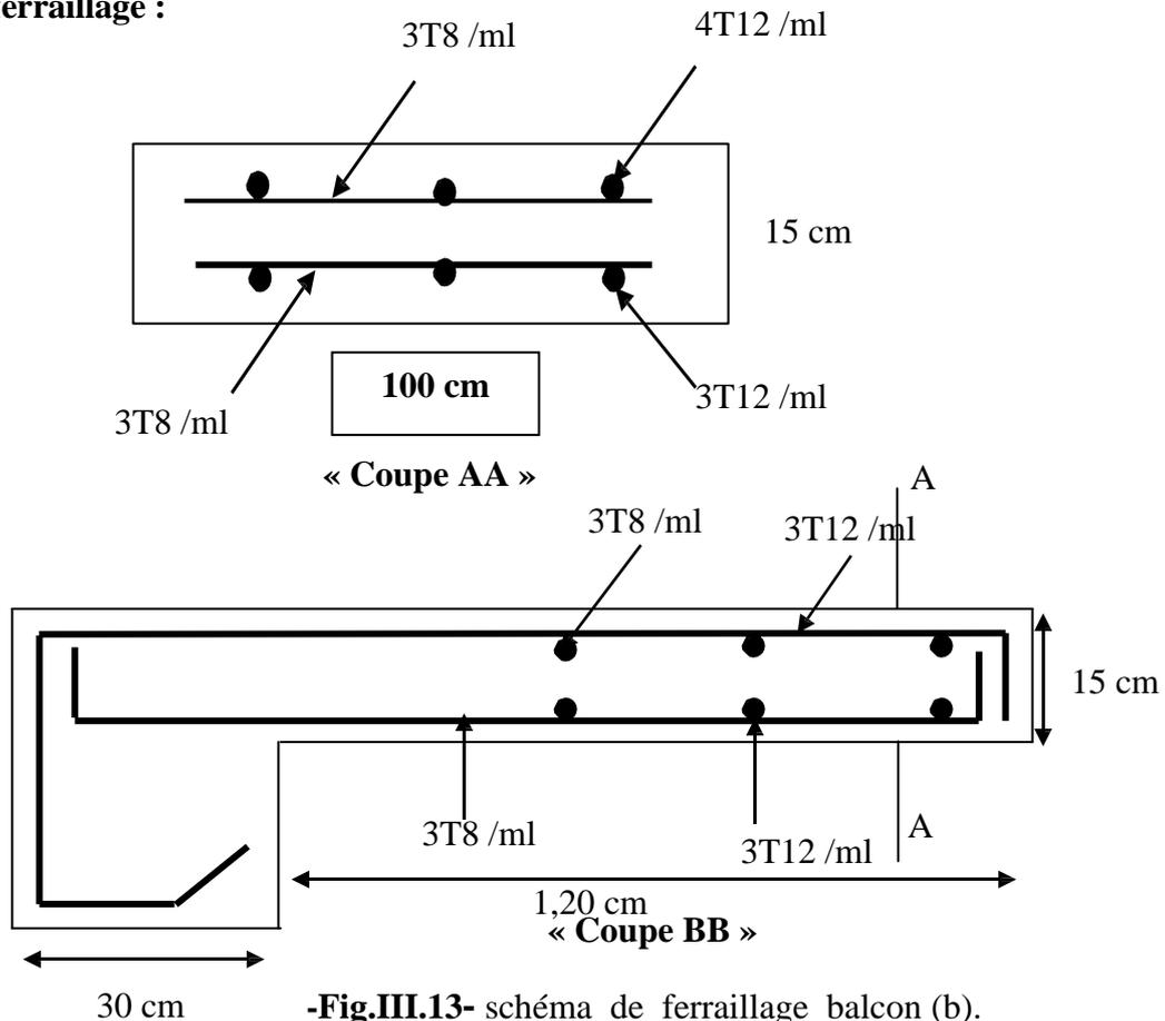
**-Fig.III.13-** schéma de ferrailage balcon (b).
