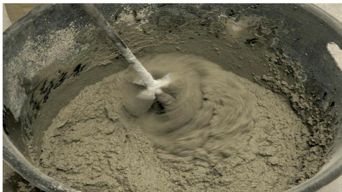
**Figure. I.1** : mélange de mortier.
