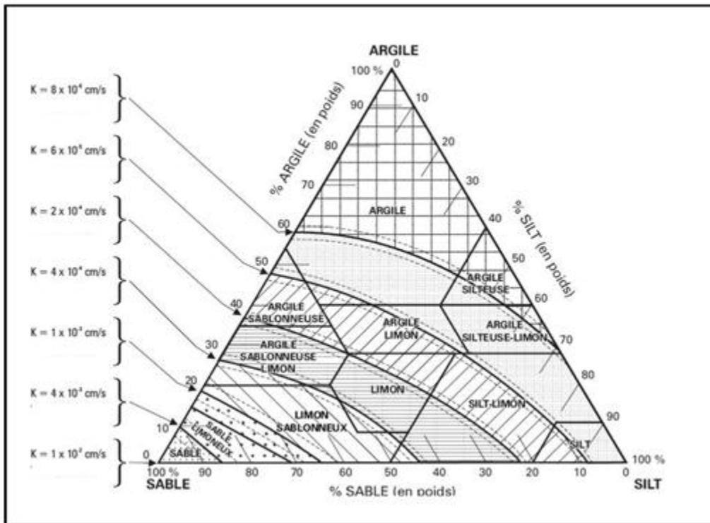
Figure : corrélation entre texture du sol et sa valeur probable de conductivité hydraulique (inspiré de figure 5.4 de Dubé et al.1996 et de Hantzsche et al.1981)
