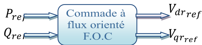
Fig.III.2: Bloc de contrôle à flux orienté.
