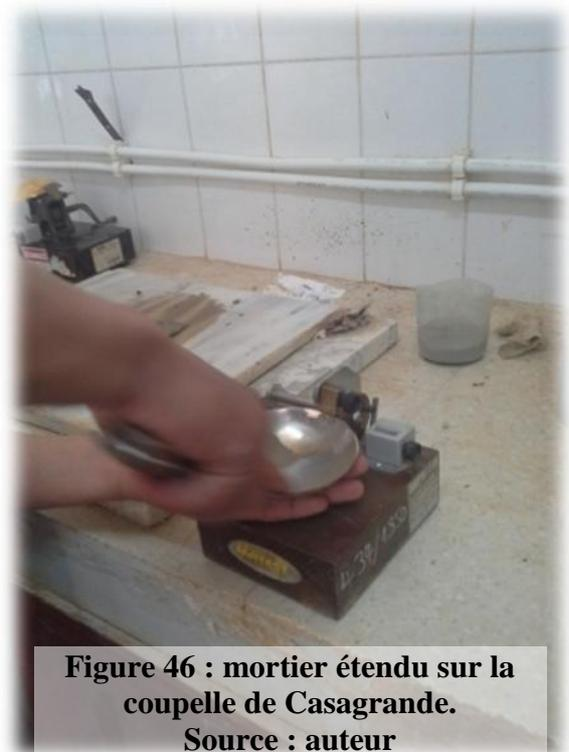
Figure 46 : mortier étendu sur la coupelle de Casagrande.
