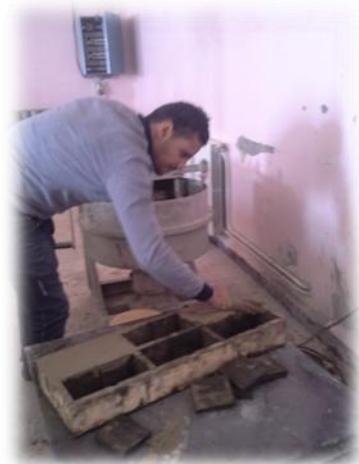
**Figure 56 confectionnement d'éprouvette d'adobe**
