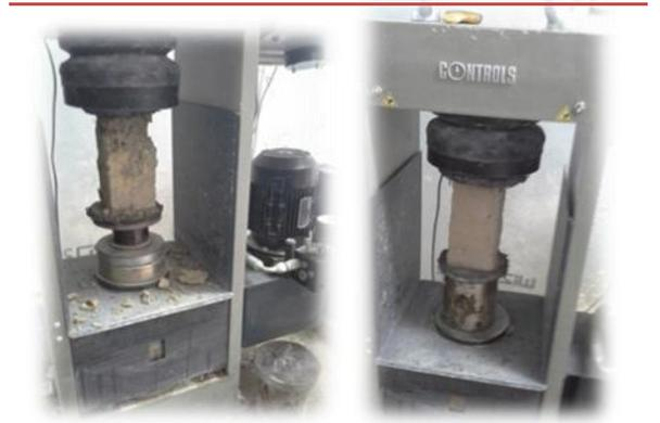
**Figure 58 : écrasement d'éprouvette d'adobe**
