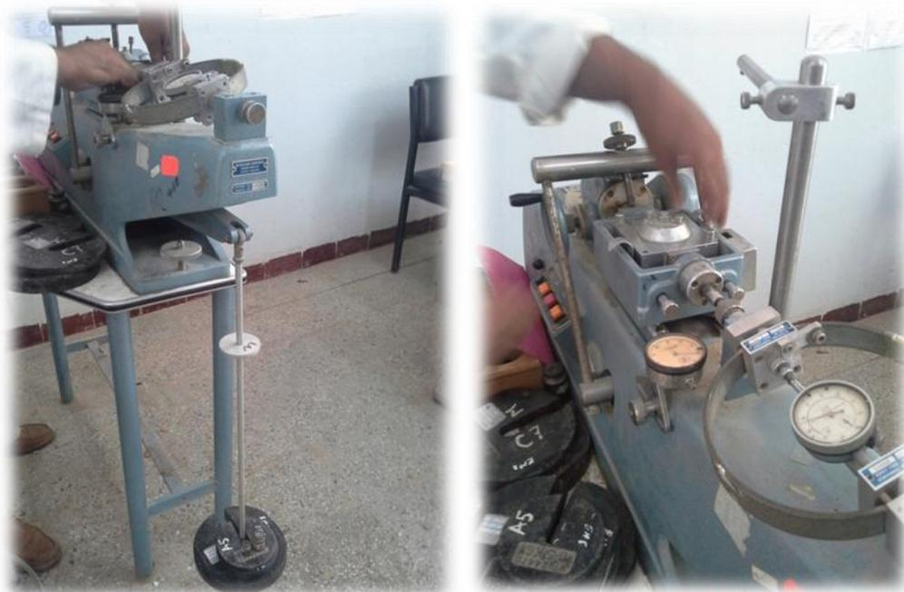
**Figure 51: essai de cisaillement (en LTPO Tiaret)**
