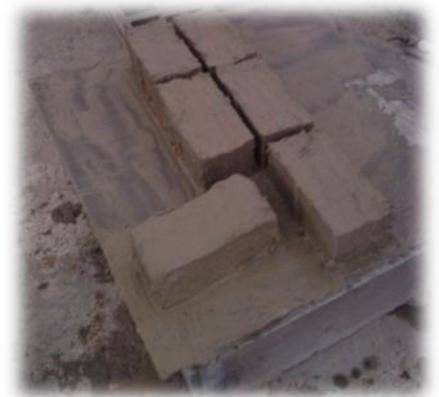
**Figure 57: stockage d'éprouvette d'adobe**
