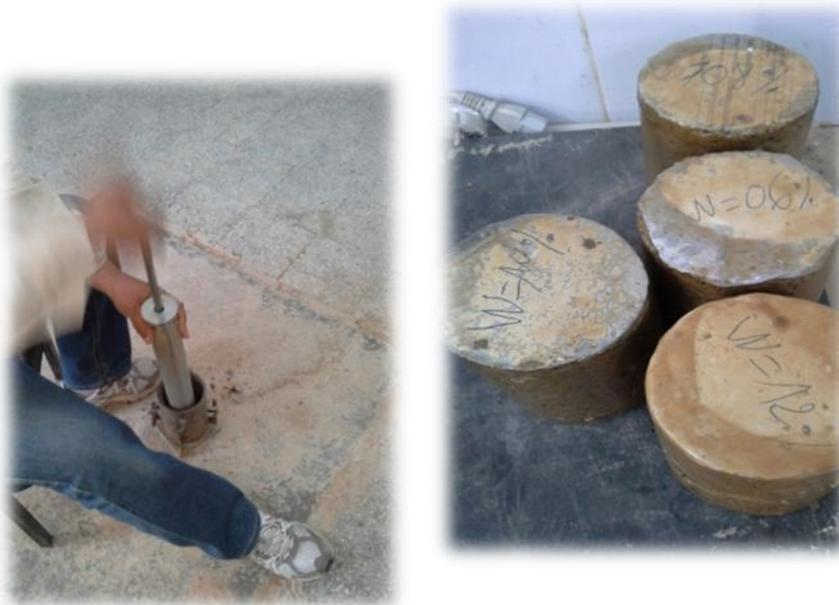
**Figure 49: Opération d'essai du PROCTOR**
