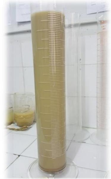
**Figure 36: test de sédimentation.**
