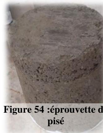
Figure 54 :éprouvette de pisé
