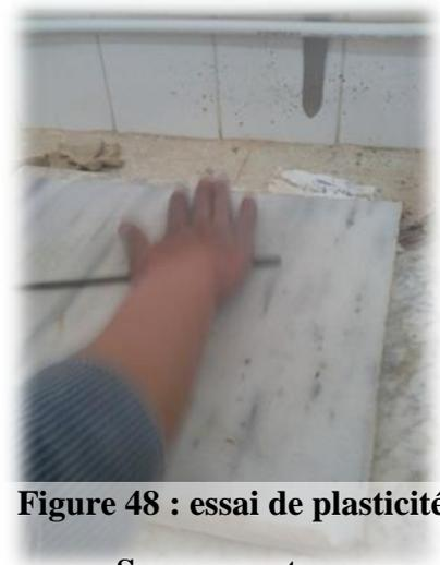
**Figure 48 : essai de plasticité**
