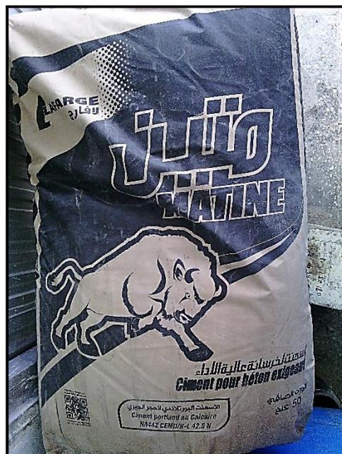
Figure V.1 : Ciment utilisé CEMII/B-L 42.5N
