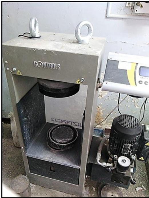
**Figure V.39 :** Machine d'essai d'écrasement
