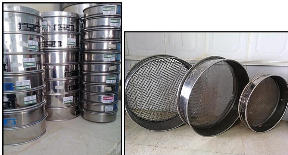
**Figure V.4 : Les tamis utilisés**
