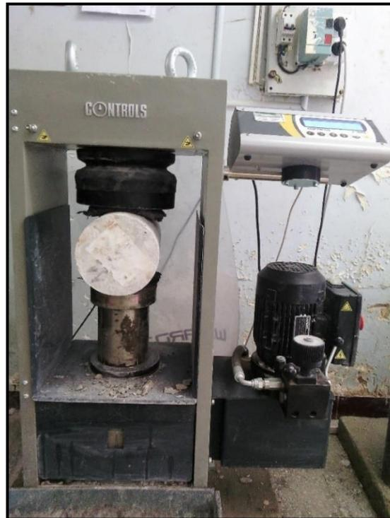
**Figure V.41 :** Chargement des éprouvettes cylindriques, essai de traction par fendage
