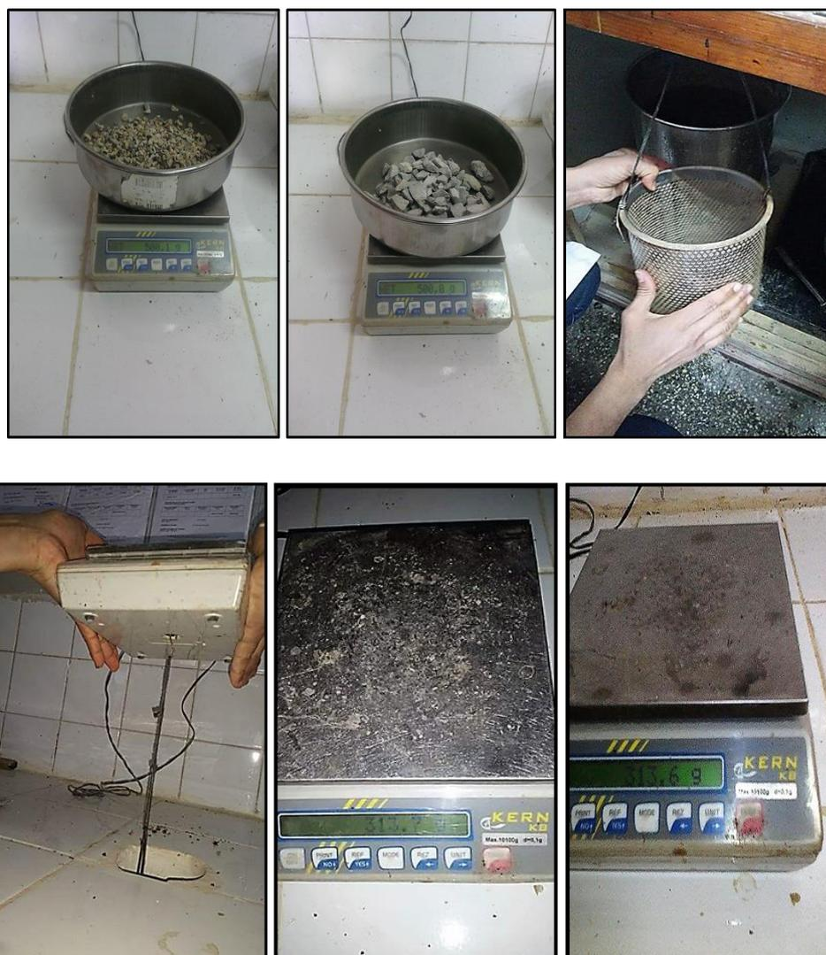
**Figure V.12 :** Détermination de la masse volumique absolue du gravier (3/8 et 8/15)
