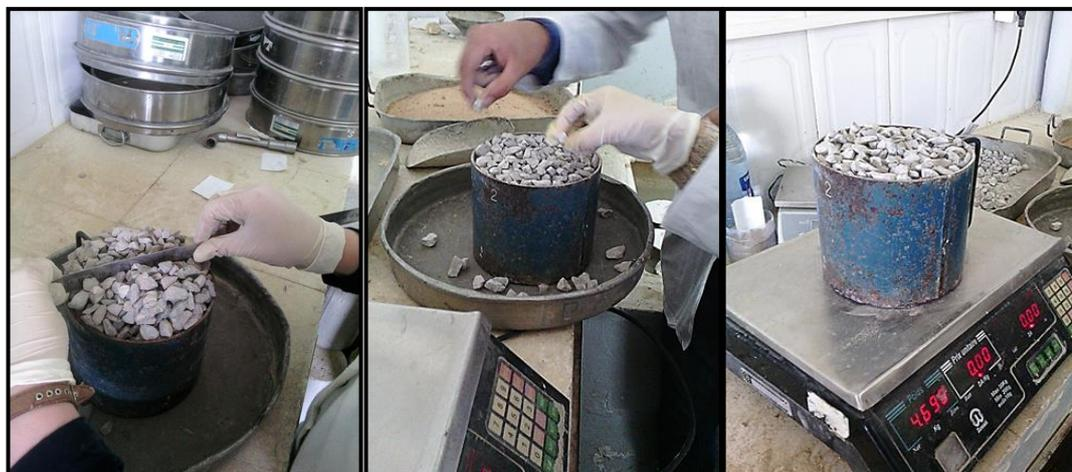
**Figure V.11 :** Essai de détermination de la masse volumique apparente du gravier 8/15
