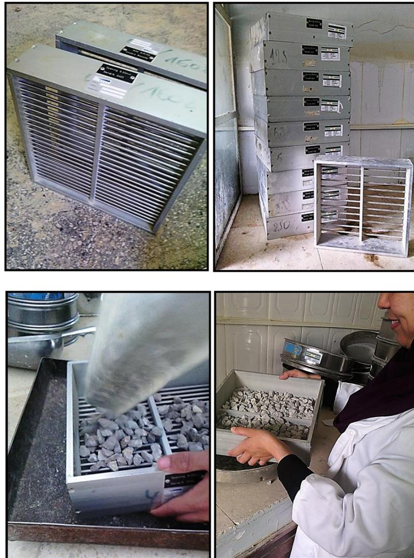
**Figure V.9 :** Détermination du coefficient d'aplatissement C.A
