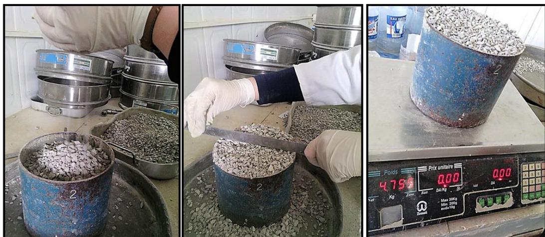
**Figure V.10 :** Essai de détermination de la masse volumique apparente du gravier 3/8
