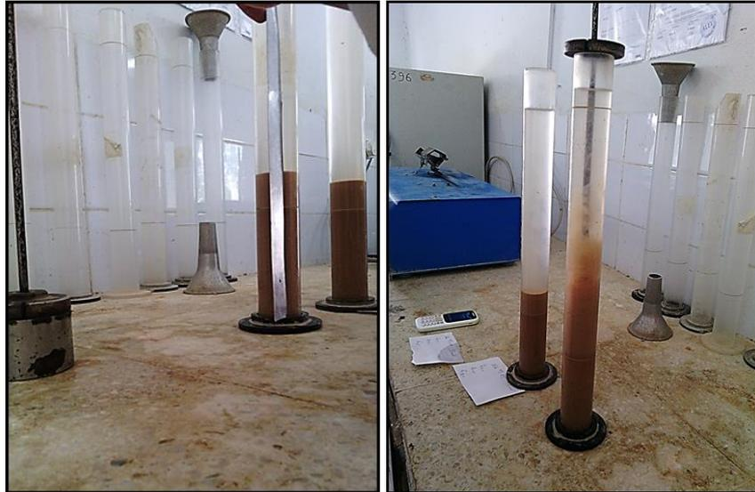
Figure V.23 : Détermination des hauteurs (h1, h'2) visuel et par piston
