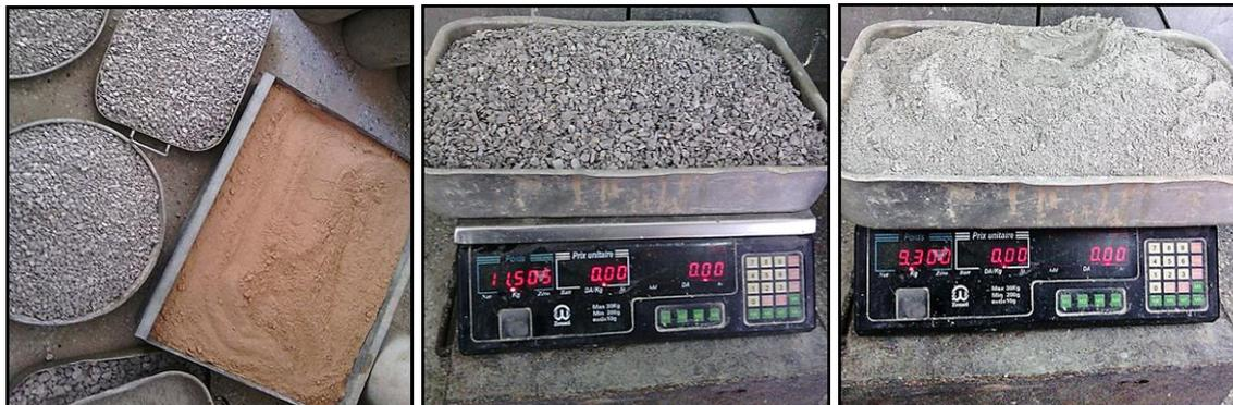
**Figure V.30** : Préparation des ingrédients secs pour la confection des mélanges de béton (BO , BHP)
