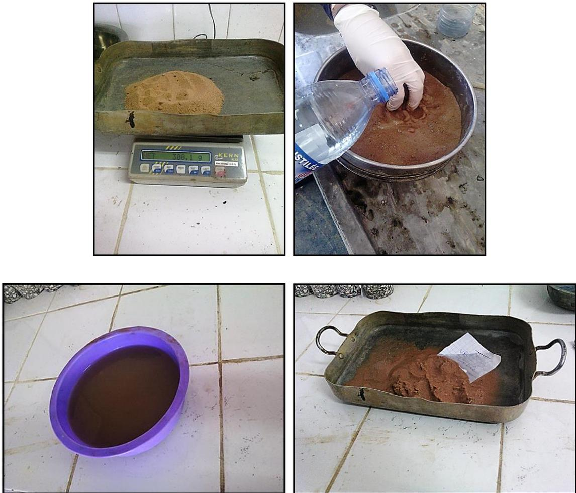
**Figure V.26** : Préparation d'échantillon pour l'essai au bleu
