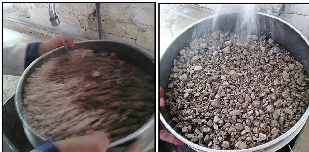
**Figure V.16 :** Echantillon après l'essai L.A
