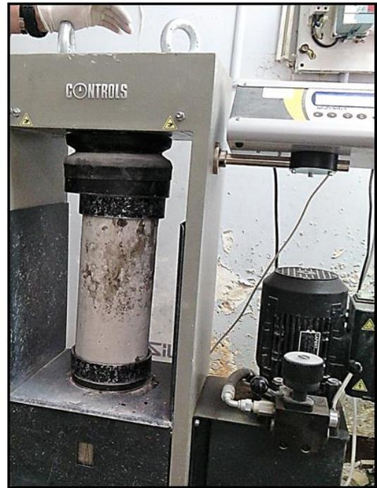
**Figure V.40 :** Chargement des éprouvettes cylindriques pour essai de compression
