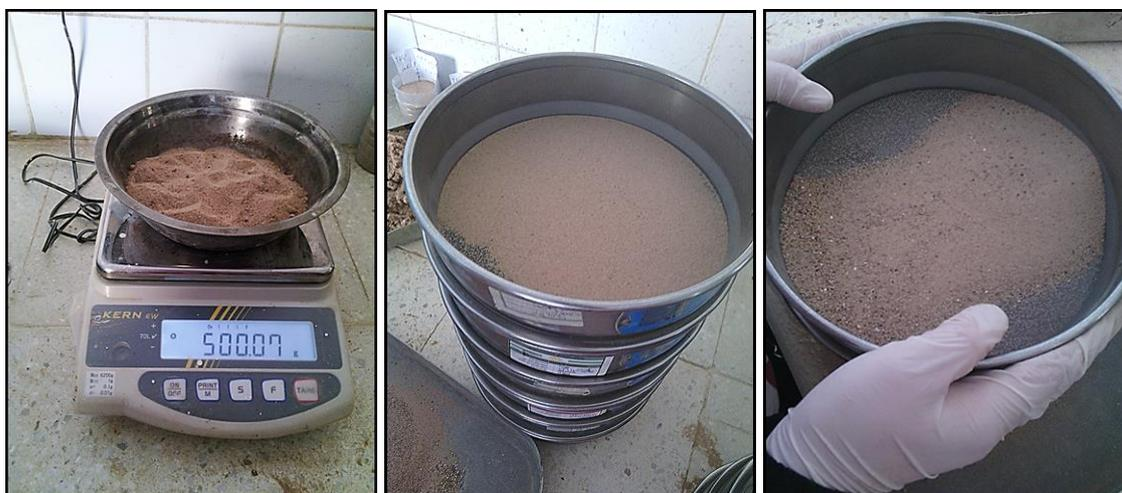
**Figure V.19 :** Essai d'analyse granulométrique (sable)
