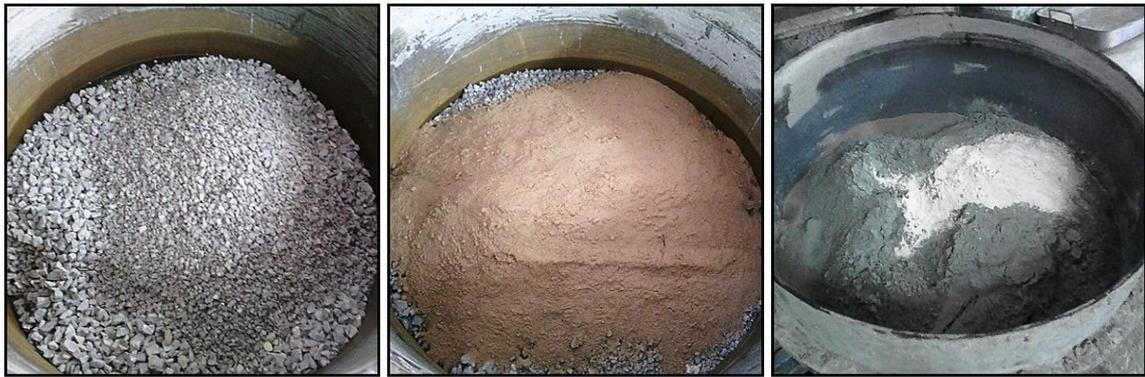
**Figure V.31 :** Préparation des constituants dans la cuve du malaxeur
