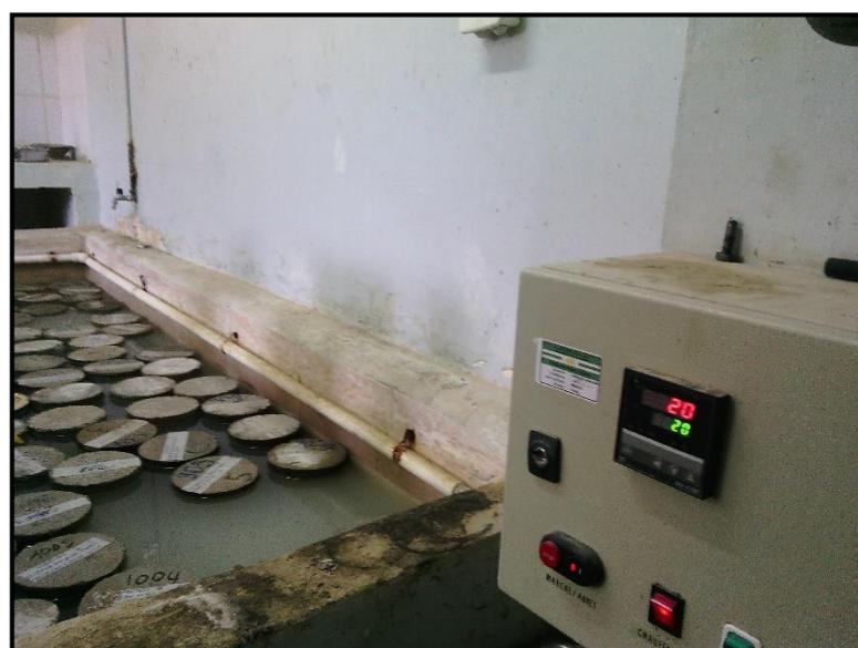
Figure V.38 : Conservation des éprouvettes dans l'eau
