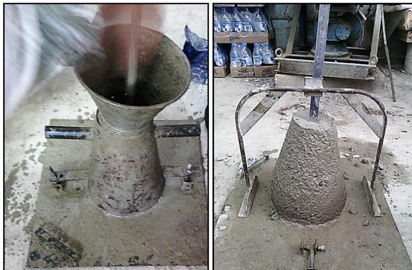
**Figure V.35 :** Mesure de l'affaissement du béton par slump-test « cône d'Abrams »
