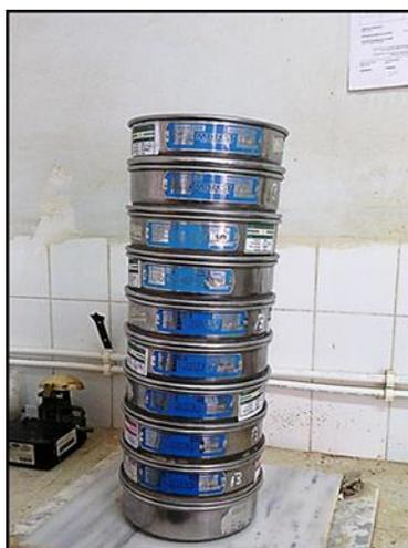
**Figure V.18 :** Colonne des tamis utilisés
