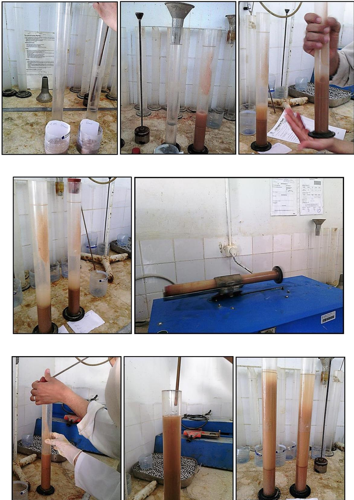
Figure V.22 : Essai d'équivalent de sable
