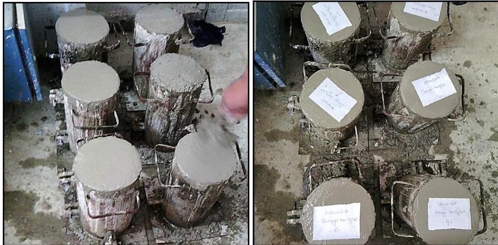
Figure V.37 : Conservation des éprouvettes avant démoulage
