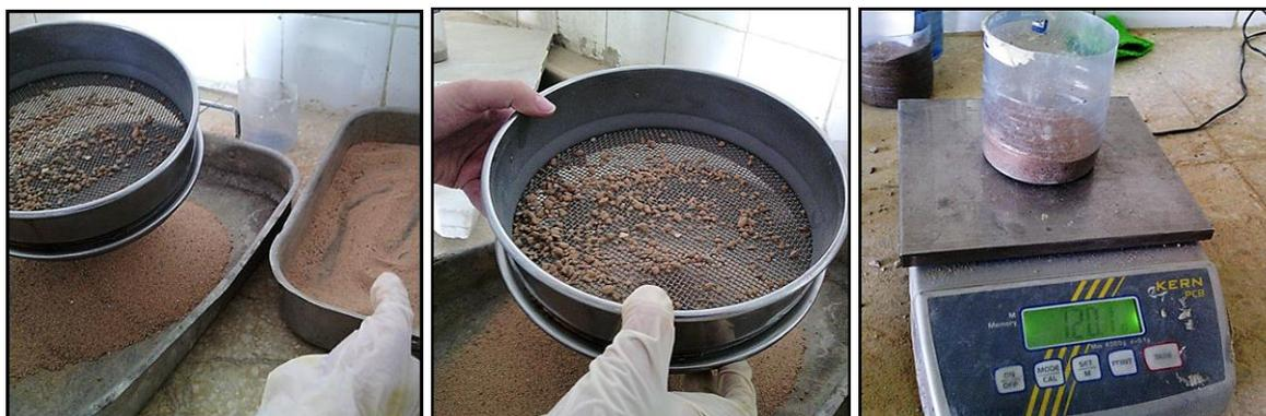
**Figure V.21 :** Préparation d'un échantillon de sable pour l'essai ES
