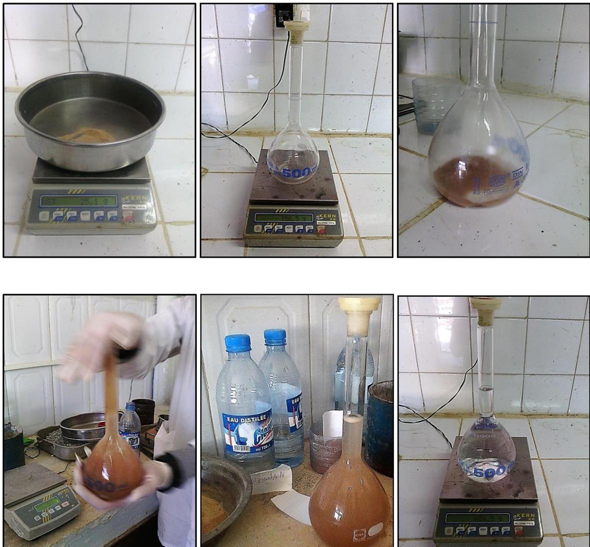
**Figure V.29** : Détermination de la masse volumique absolue du sable
