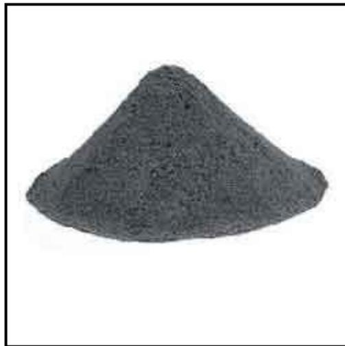
**Figure II.3 :** fumée de silice sous forme de poudre
