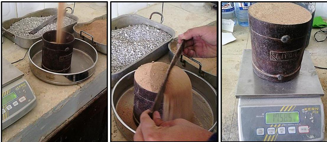
**Figure V.28** : Essai de détermination de la masse volumique apparente du sable.
