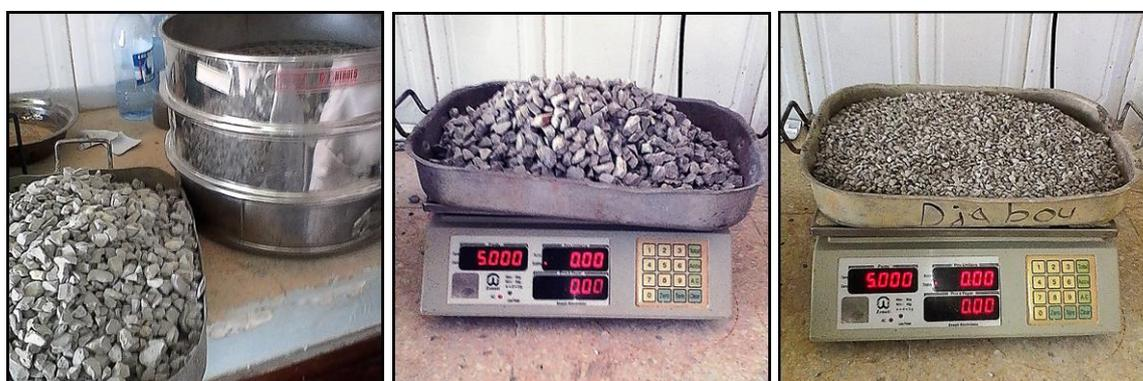
**Figure V.14** : Préparation des échantillons pour l'essai Los Angeles
