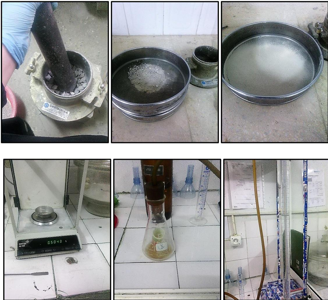
**Figure V.17 :** Essai pour la détermination des carbonates dans les graviers (3/8 et 8/15)
