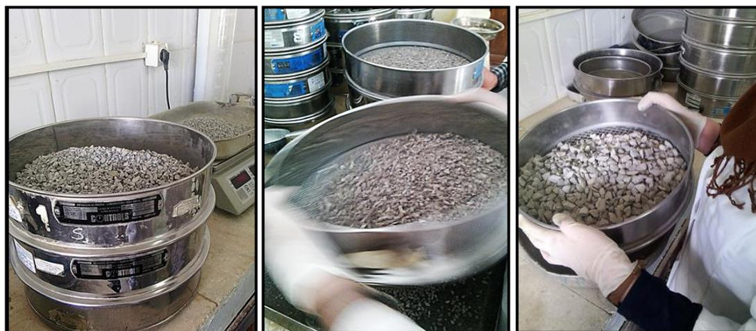
Figure V.5 : Essai d'analyse granulométrique.
