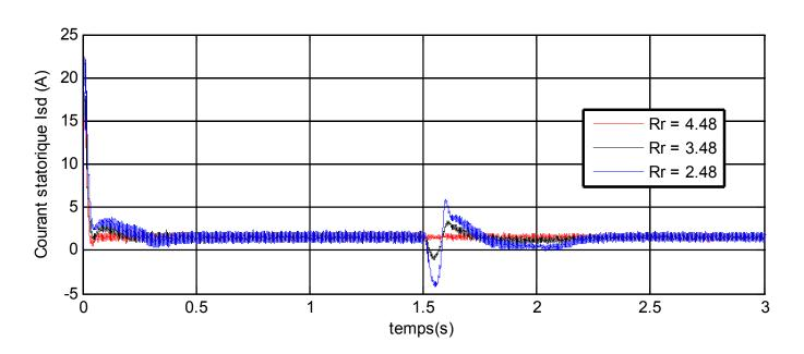
Figure IV . 12 courant *Isd* pour des différente Rr
