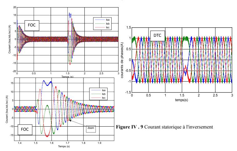
Dans le cas de la technique FOC il y a un appel du courant au démarrage (11 fois Is) et à l'inversement du sens de rotation (15 fois Is).
