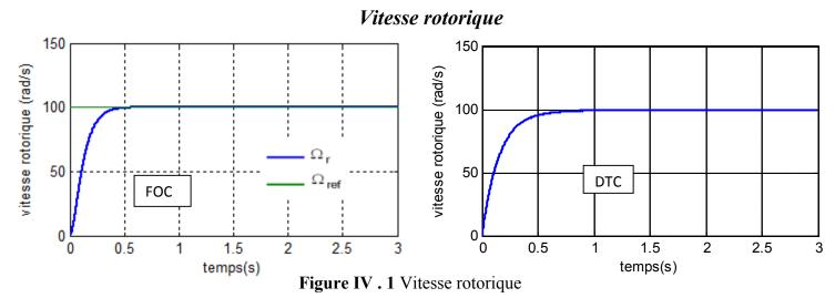
On remarque que le temps de réponse en vitesse de la technique FOC ( t=0.3 s ) est plus rapide que celle de la DTC ( t=0.6 s ).
