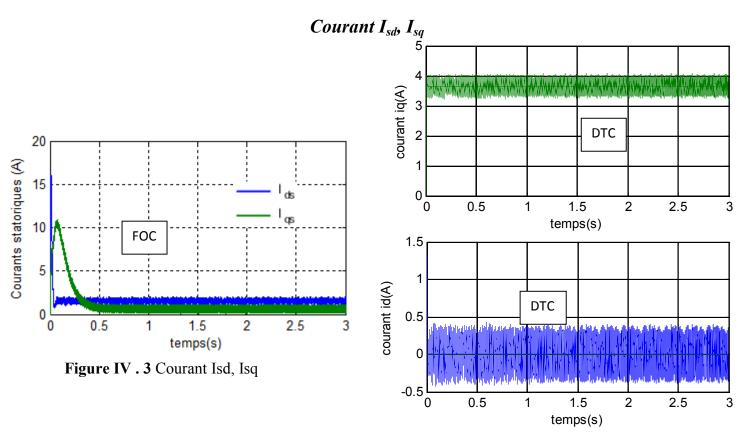
On remarque que dans le cas du FOC le courant **Iq** a un dépassement au démarrage mais il se stabilise après un certain temps par contre dans le cas du DTC le courant **Iq** est stable des le début.
