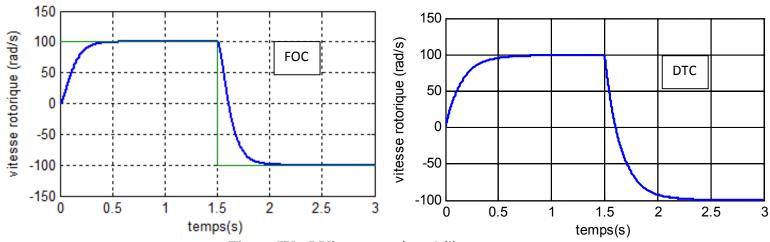
Figure IV . 5 Vitesse rotorique à l'inversement
