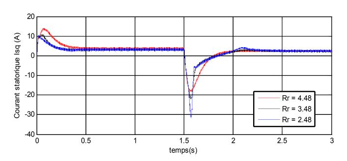
Figure IV . 13 courant *Isq* pour des différente Rr
