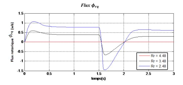
**Figure IV** . **15** Flux  $oldsymbol{\phi_{rq}}$  pour des différente Rr
