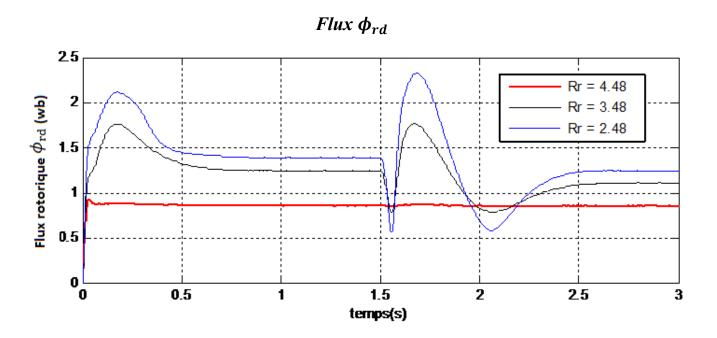
**Figure IV . 14** Flux  $oldsymbol{\phi_{rd}}$  pour des différentes Rr
