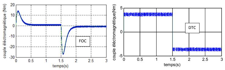
Figure IV . 6 Couple électromagnétique à l'inversement
