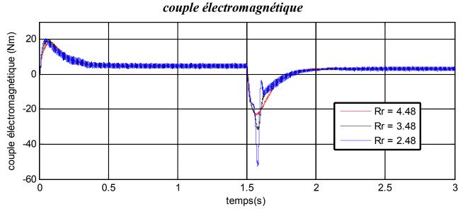
Figure IV . 11 couple électromagnétique pour des différente Rr
