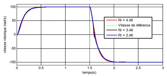
Figure IV . 10 vitesse de rotation pour des différente Rr
