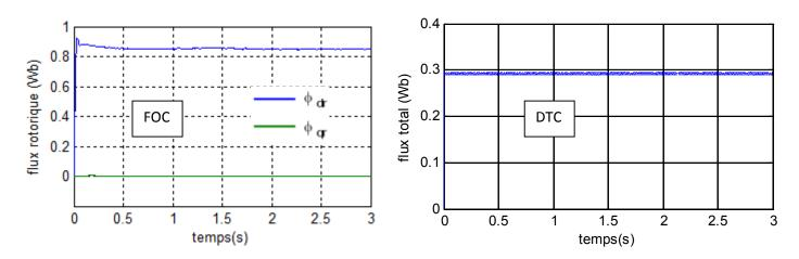
Figure IV . 4 Flux rotoriques  $\Phi_{rd}$   $\Phi_{rq}$
