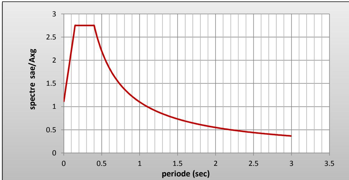
Figure.v.14 Spectre de réponse élastique- composante horizontal- 5% d'amortissement
